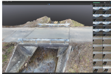
UAV近接点検の画像から高精細な3D画像を作成
